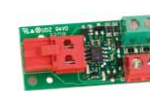
Interfaz BUS XIB (Si la tarjeta E024S se utiliza con fotocélula no Bus)
