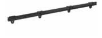
Cremallera de nylon reforzada 30x20 con interior de acero y accesorios de instalación (paq. de 4 m para cancela con peso máx. 400 kg)
